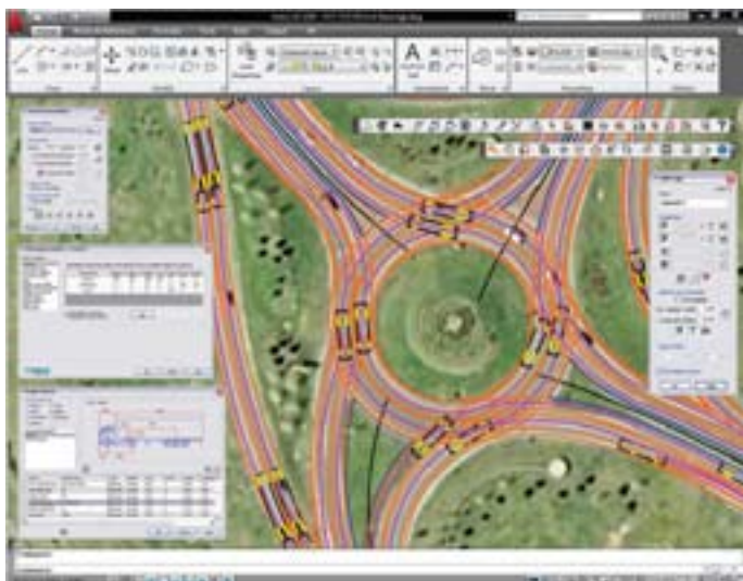
Generování kruhových objezdů na základě vlečných křivek vozidel a rychlosti vám ušetří množství času během návrhu.
