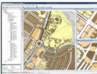
Vzhled objektů je závislý na jejich vlastnostech, např. tématické zobrazení vodovodních trubek v návaznosti na jejich průměr
